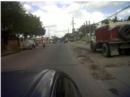
*Tramo Autopista 30 de mayo, sentido ZF Itabo-Puerto de Haina. Vialidad con usos mixtos en el derecho de vía, sin demarcación, con pavimento en malas condiciones, vehículos estacionados a ambos lados.*
