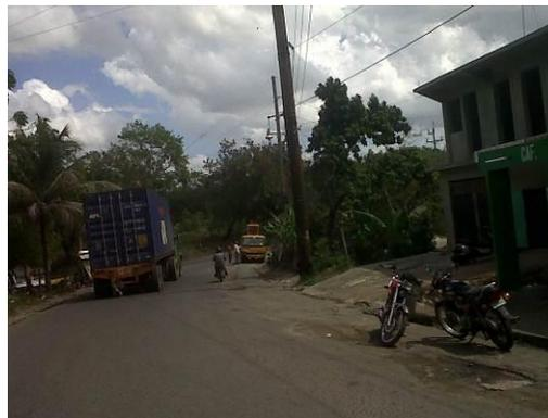
*Tramo Autopista 30 de mayo, sentido ZF Itabo-Puerto de Haina. Vialidad con usos mixtos en el derecho de vía, sin demarcación, con pavimento en malas condiciones, vehículos estacionados en sentido contrario y transporte de carga circulando por el carril izquierdo.*
